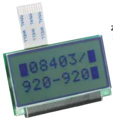
2-zeiliges LC-Display mit 8 Zeichen pro Zeile und industriestandard-kompatiblem Controller (HD47780 kompatibel). Der Anschluss erfolgt wahlweise über das 10-polige Flachband-Kabel oder über Lötpunkte.
